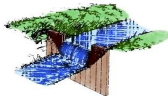
Particolare del manufatto di regolazione del livello delle acque nei rii di collegamento
