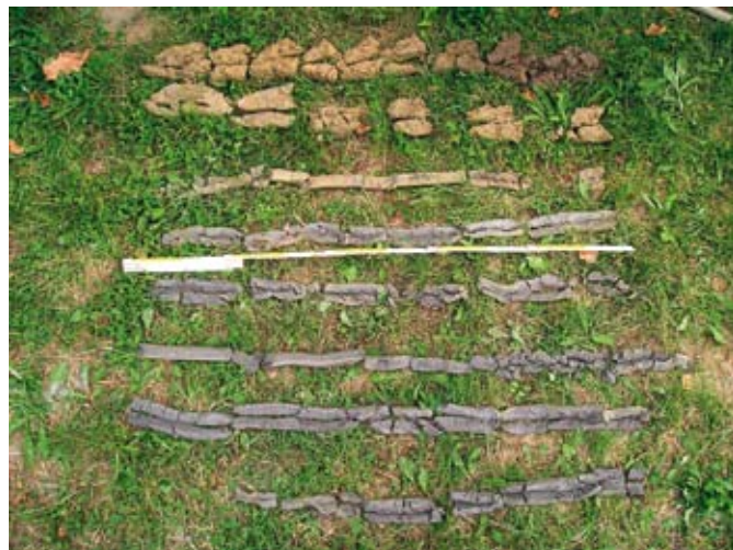
Fig. 3.5. Campioni estratti da una trivellata manuale di 7,80 m nei pressi di Meolo (foto Abbà T., Provincia di Venezia, 2006).
