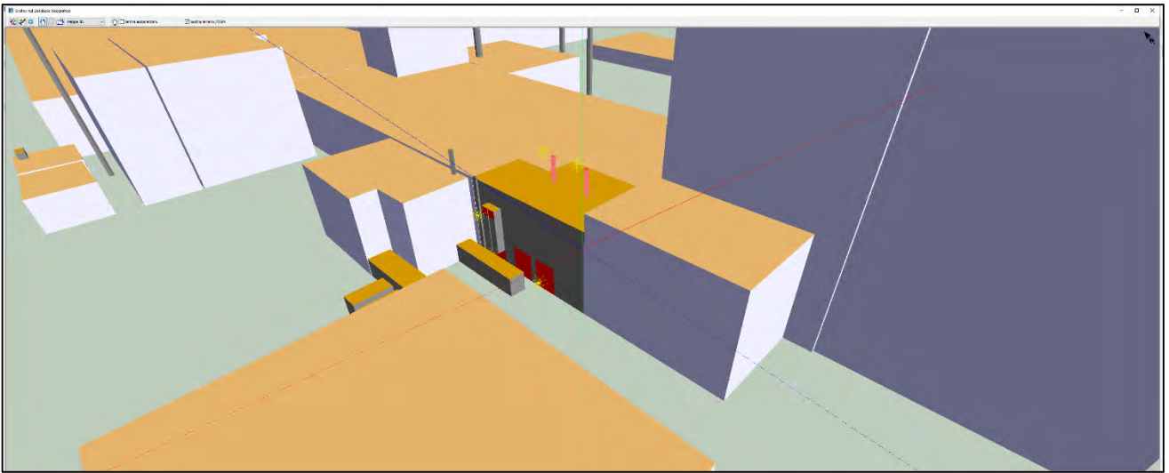
Figura 6 Vista generale sorgenti centrale termica + sala compressori Kaeser (sorgenti fisse).
