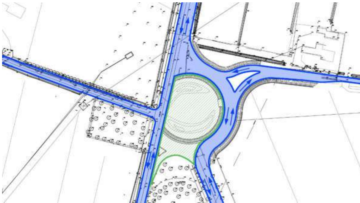
Figura 37 - Fase B.2 di cantiere (in verde); in blu la viabilità attività con i flussi di traffico.
