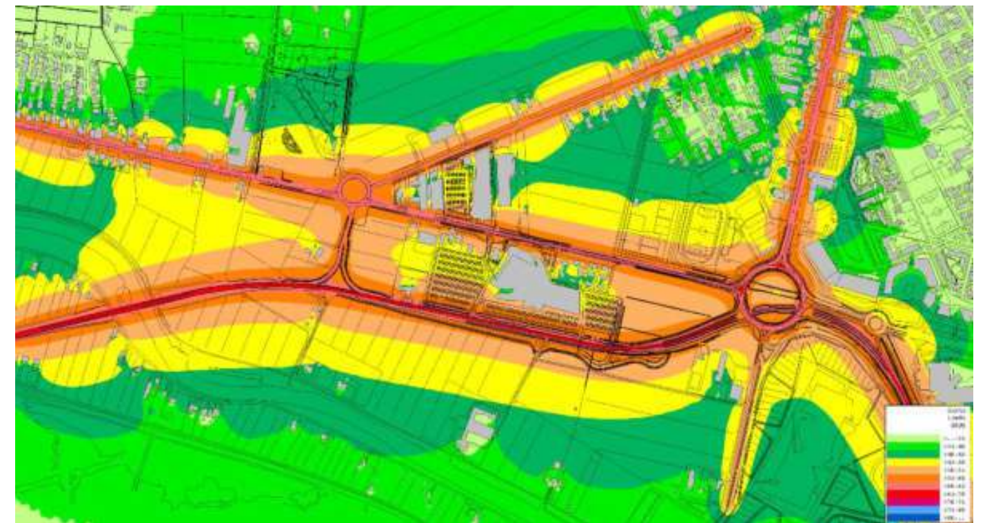
Figura 185 - Rappresentazione dell'isolivello sonoro simulato Laeq (dBA) diurno a Q. +4,00 (SDP2 notturno immissione - Impatti cumulativi).
