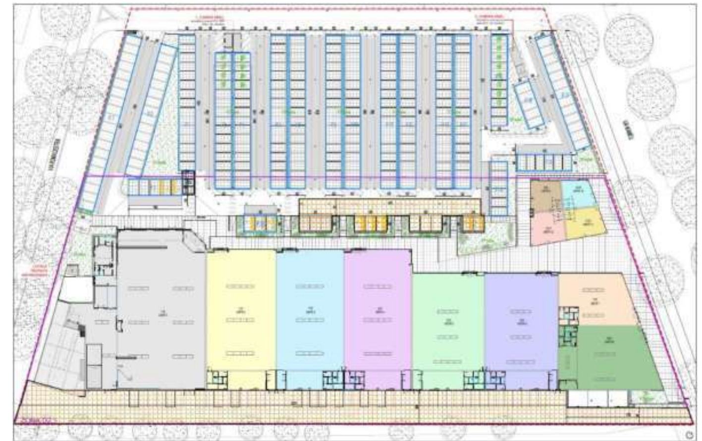
Figura 17 - Schema di progetto delle aree a standard verde e parcheggi (estratto dalla precedente procedura di Screening VIA).
