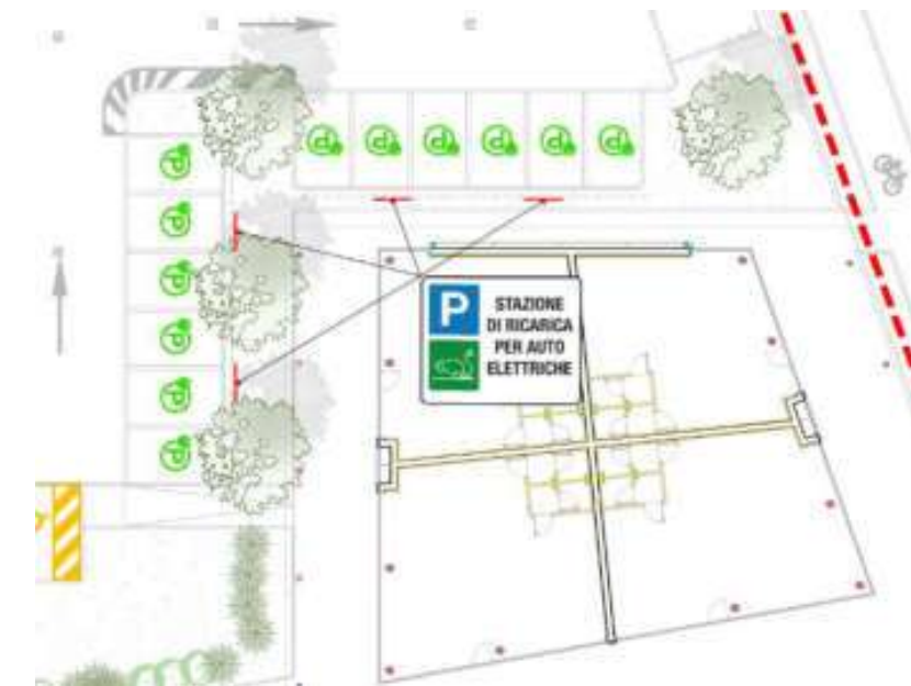
Figura 27 - Inquadramento degli stalli con possibilità di ricaricare le auto elettriche.
