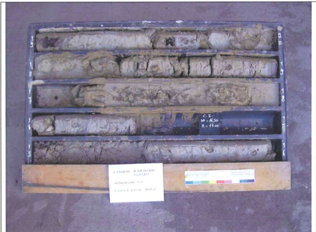
Sondaggio SA – Cassetta N. 4 : da 15.0 m a 20.0 m
