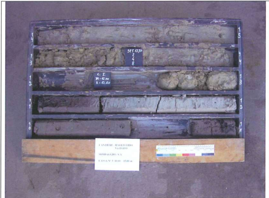
Sondaggio SA – Cassetta N. 3 : da 10.0 m a 15.0 m
