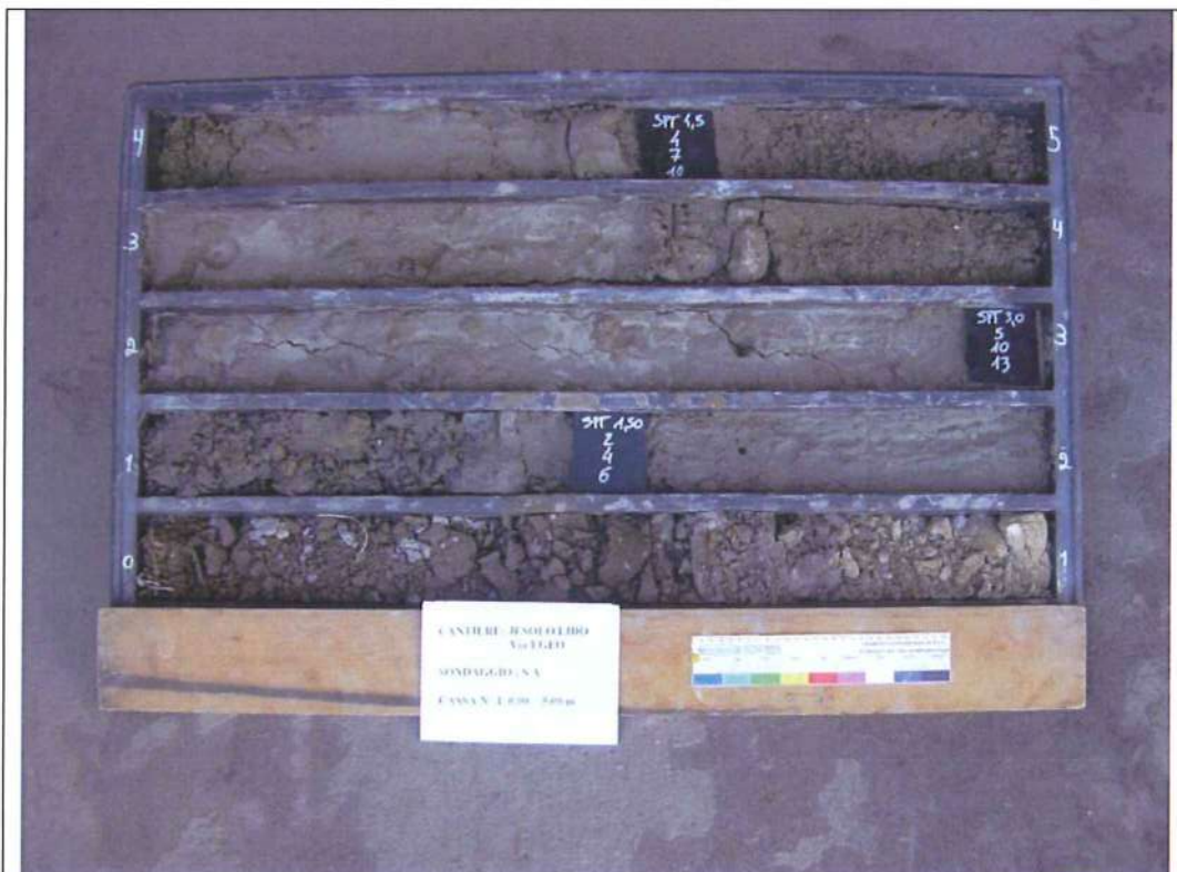
Sondaggio SA – Cassetta N.1 : da 0.0 m a 5.0 m
