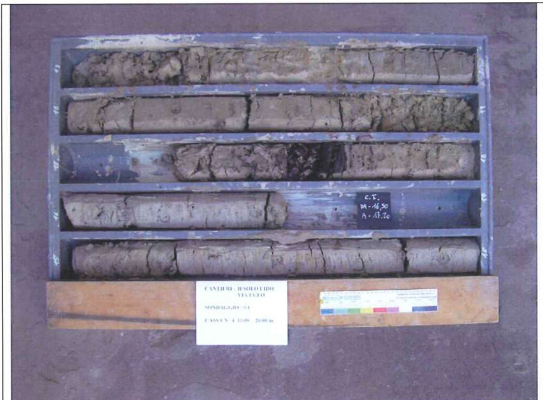
Sondaggio SC – Cassetta N. 4 : da 15.0 m a 20.0 m
