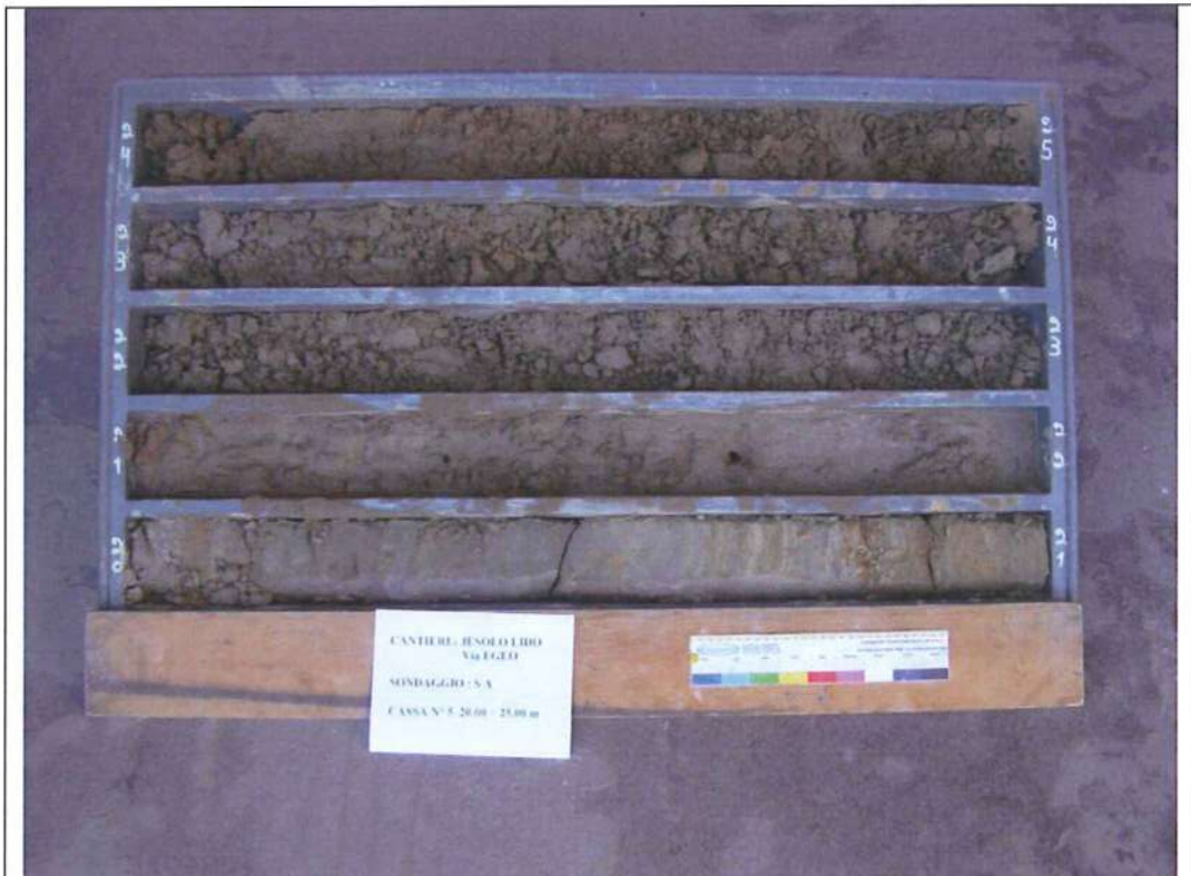
Sondaggio SA – Cassetta N.5 : da 20.0 m a 25.0 m
