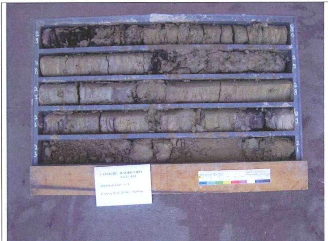
Sondaggio SA – Cassetta N. 6 : da 25.0 m a 30.0 m
