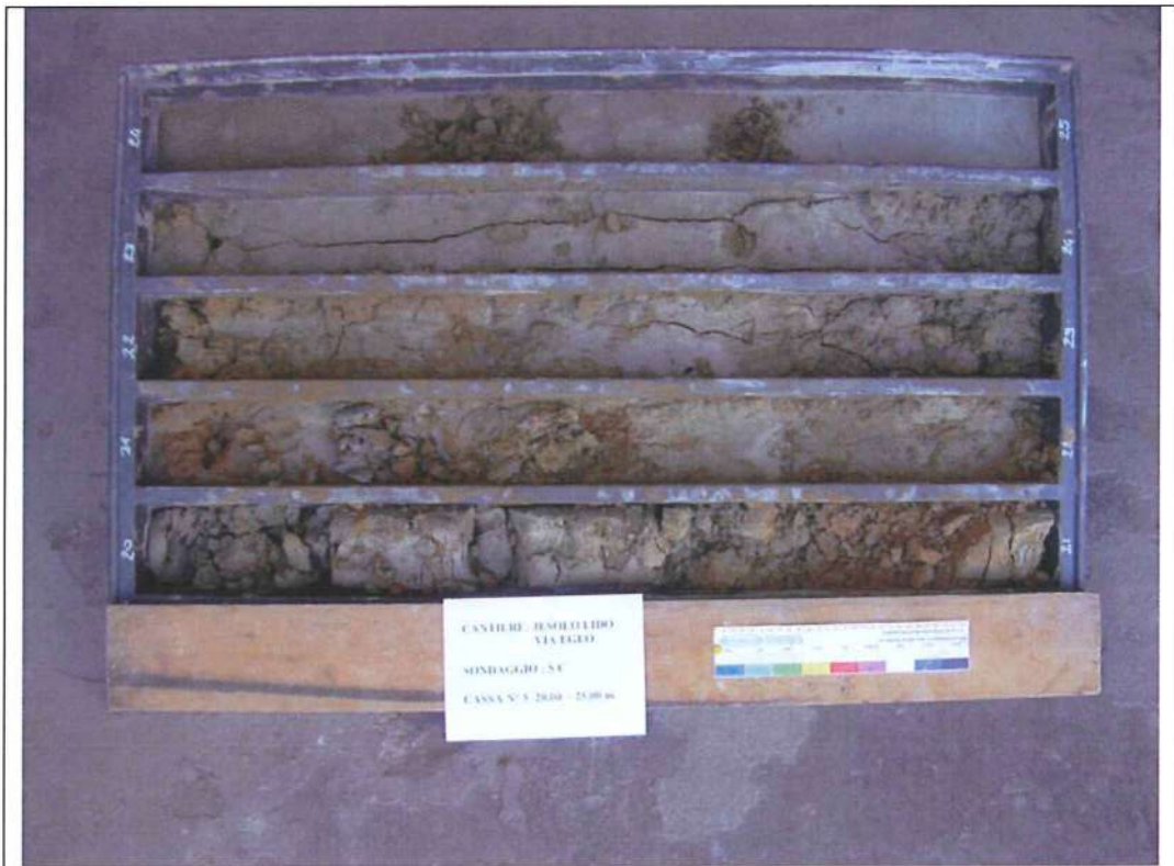
Sondaggio SC – Cassetta N.5 : da 20.0 m a 25.0 m
