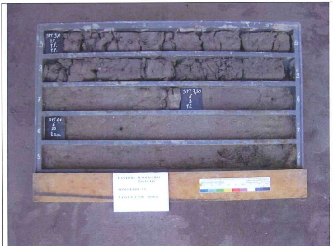
Sondaggio SC – Cassetta N. 2 : da 5.0 m a 10.0 m
