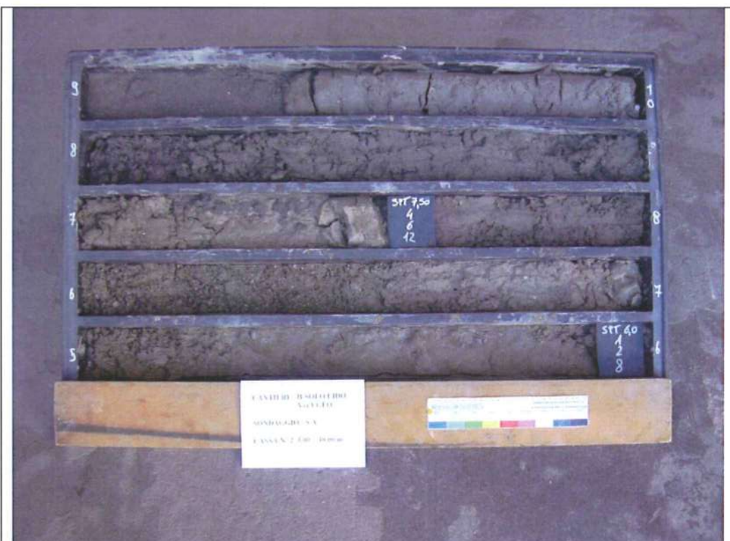
Sondaggio SA – Cassetta N. 2 : da 5.0 m a 10.0 m
