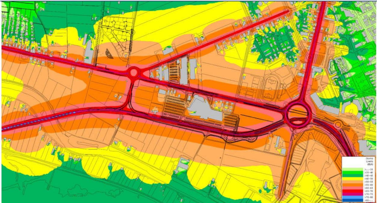
Figura 54 - Rappresentazione dell'isolivello sonoro simulato Laeq (dBA) diurno a Q. +4,00 (SDP2 diurno immissione – Impatti cumulativi).
