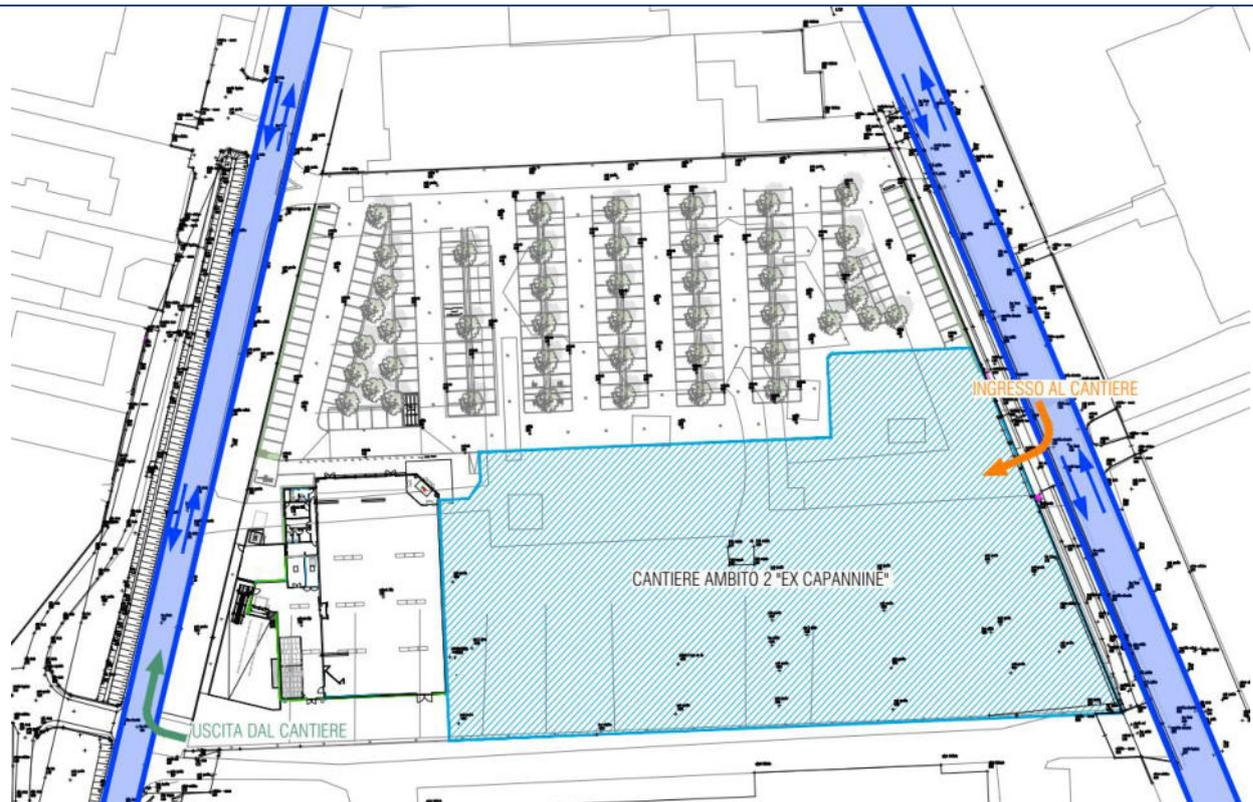
Figura 18 - Modalità di ingresso e uscita dei mezzi pesanti dall'ambito di cantiere del centro commerciale.
