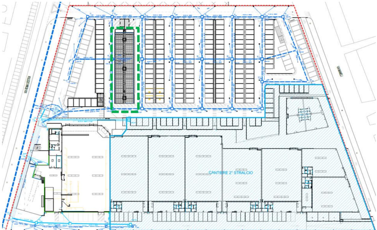
Figura 31 - Planimetria generale fognatura acque meteoriche; con linea tratteggiata verde è evidenziata la vasca di laminazione interrata, con linea blu è evidenziata la rete meteorica esistente mentre in azzurro la rete fognaria acque
