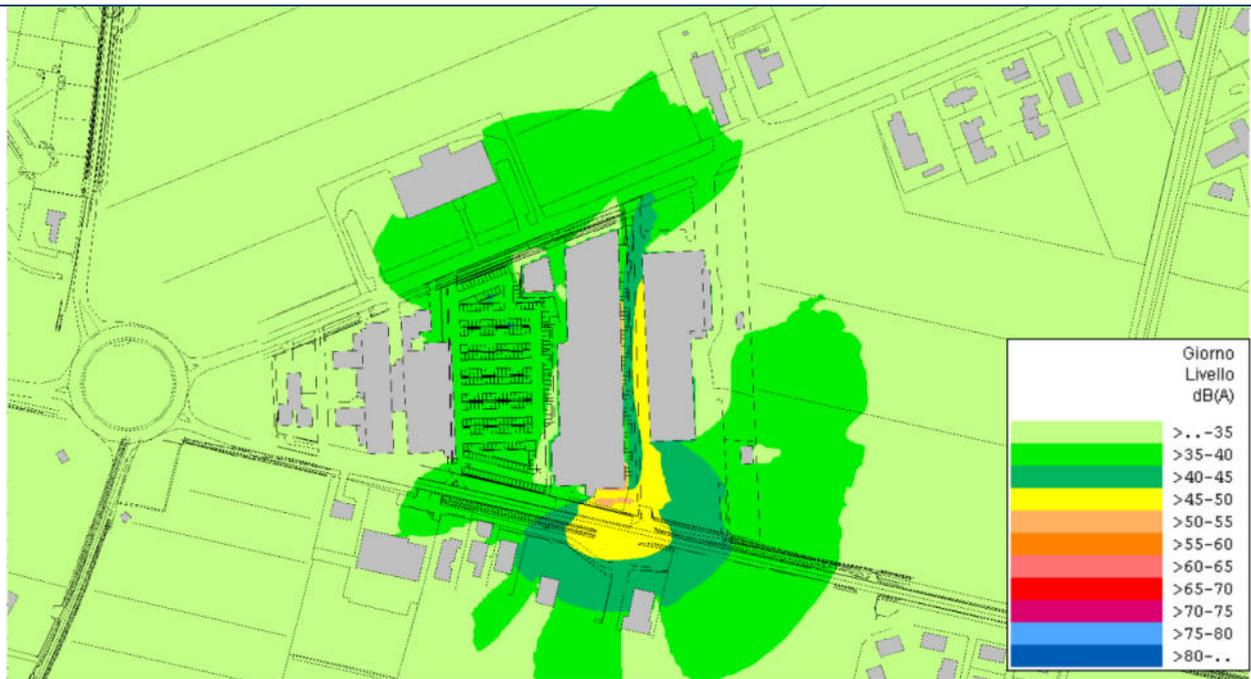
Figura 52 - Rappresentazione dell'isolivello sonoro simulato  $L_{aeq}$  (dBA) diurno a Q. +4,00 (SDP1 notturno emissione).
