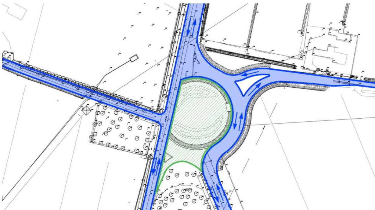
Figura 20 - Fase B.2 di cantiere (in verde); in blu la viabilità attività con i flussi di traffico.
