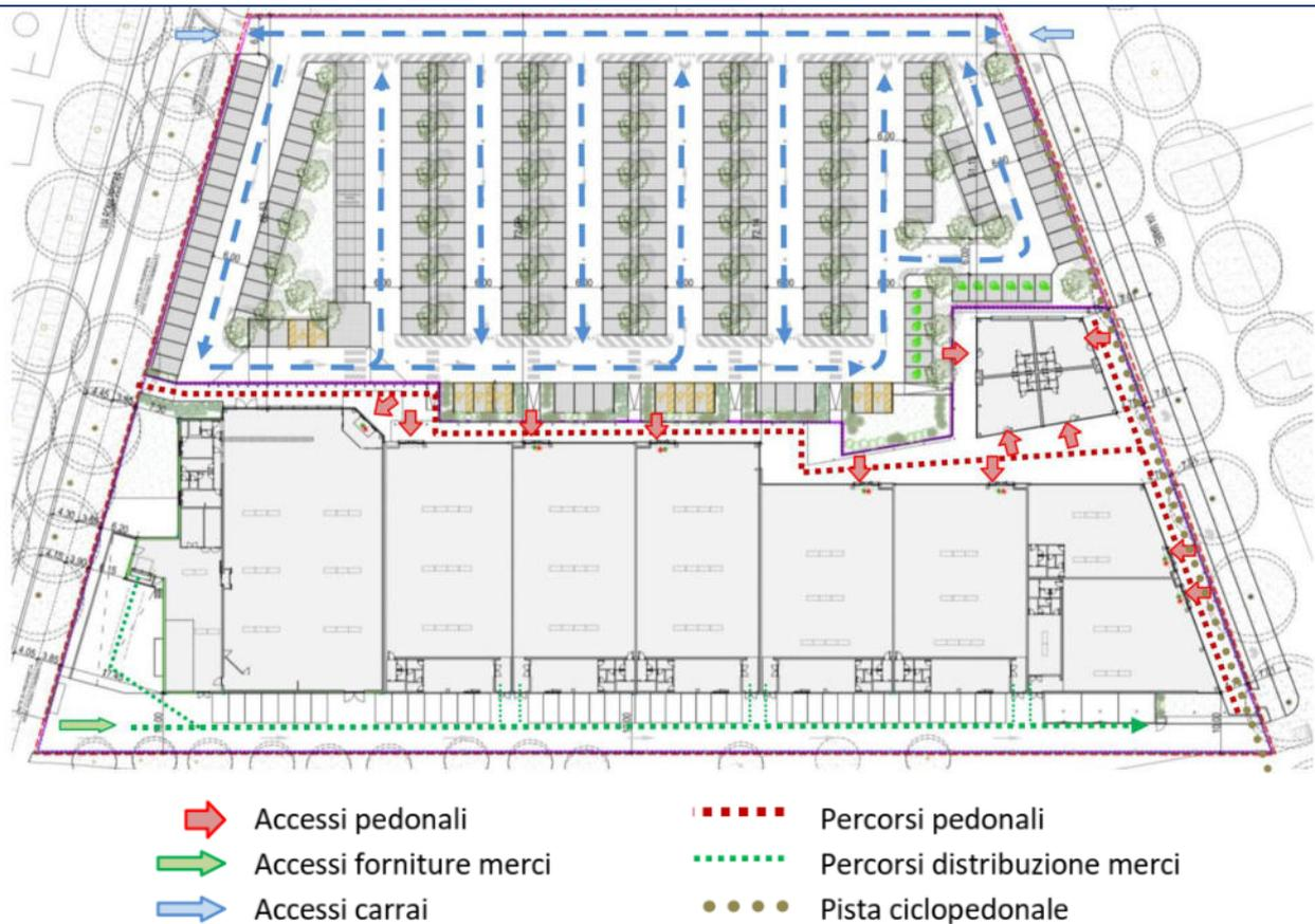
Figura 9 - Planimetria di progetto indicante flussi di circolazione e accessibilità dell'area.
