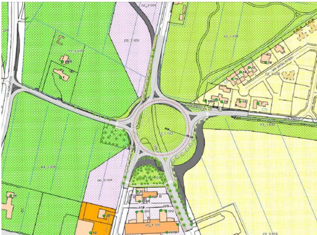
Figura 17 - Estratto del PRGC di Jesolo con sovrapposizione del sedime della rotatoria di progetto.
