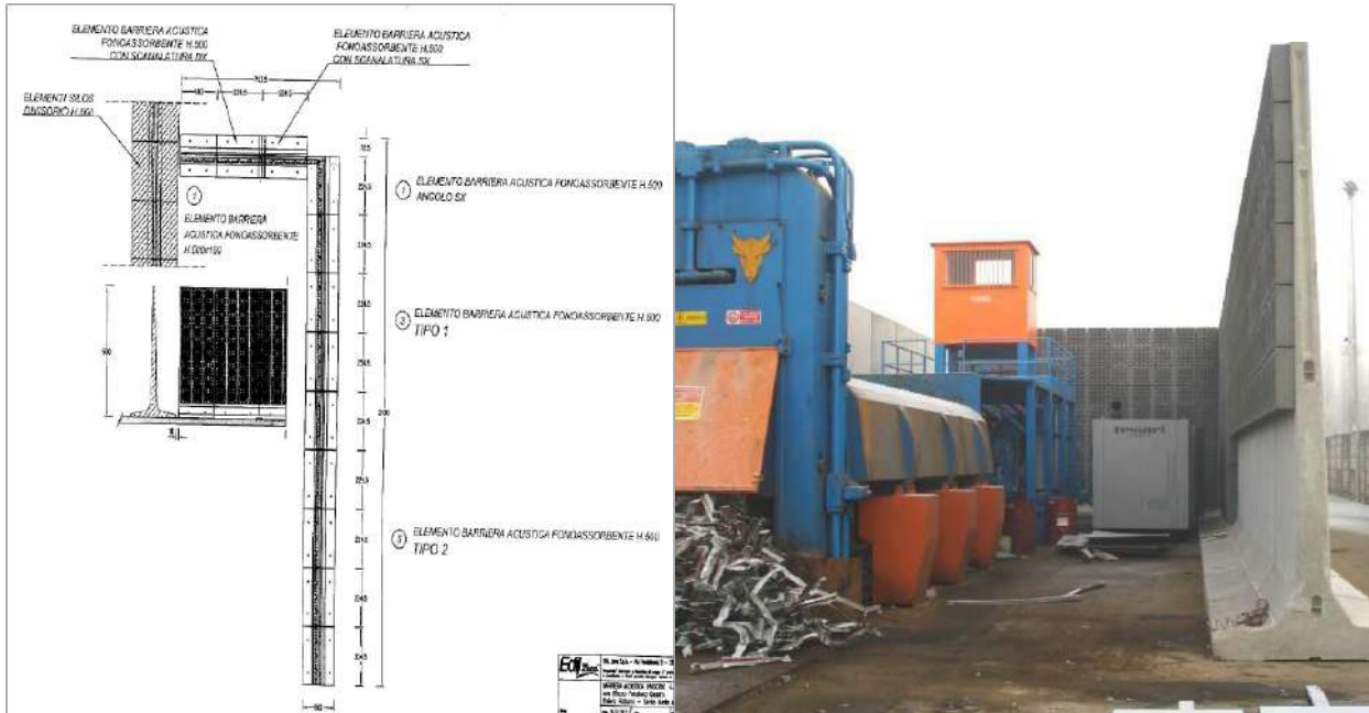
Figura 4 –Barriera antirumore in corrispondenza della pressacesoia
