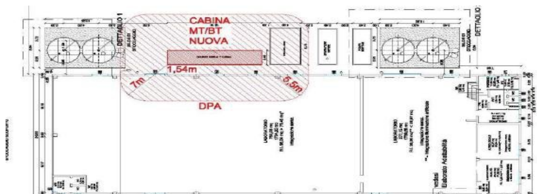
Fig.16 – Estensione DPA nuova cabina MT/BT
