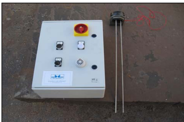
Quadro elettrico e sonde rilevamento oli
