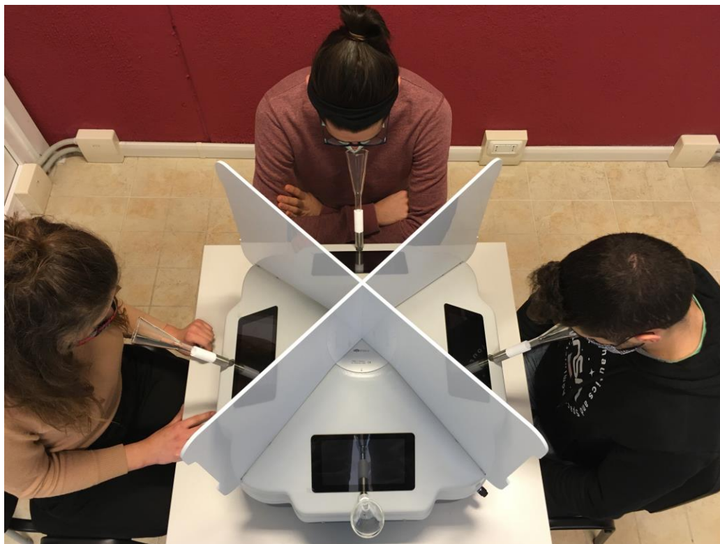
Figura 6: analisi in camera olfattometrica.
