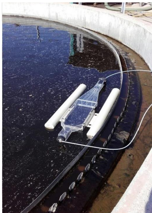
Figura 8: cappa di campionamento "wind tunnel".
