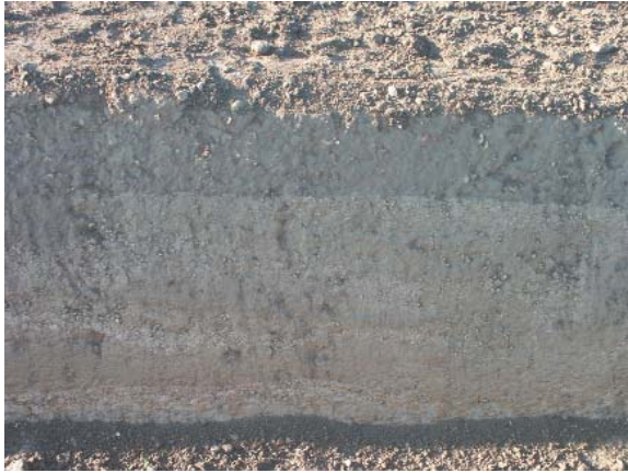
Fig. 3.9. Tipico profilo pedologico presente sulla piana alluvionale pleistocenica nella bassa pianura veneto-friulana. Si notano alternanze di accumuli di concrezioni carbonatiche dure e massive, influenzate da differenze tessiture del substrato alluvionale (Summaga di Portogruaro, località Noiare).
