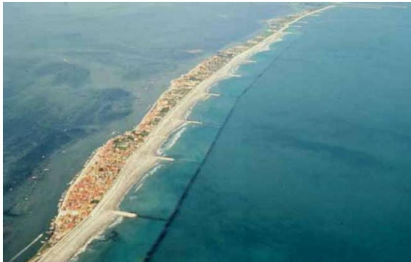
Figura 87 – Vista complessiva delle difese a mare di Pellestrina. Si nota la barriera soffolta
