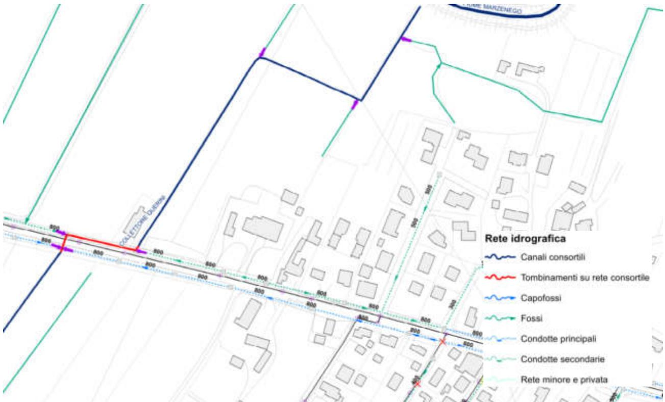
Figura 4-34: Stralcio della rete di dettaglio Maerne - fonte Piano delle acque del comune di Martellago agg. 2018
