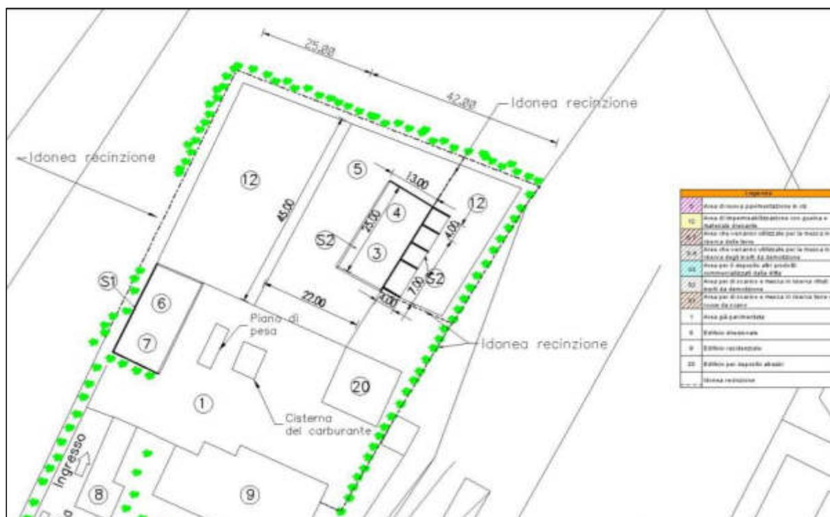
Figura 3-6: Quotatura delle aree preposte alla messa in riserva e trattamento
