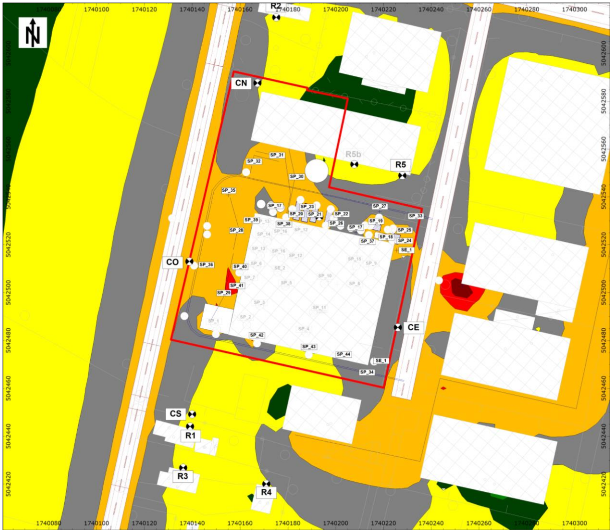
Figura 9-2 – Diffusione dei livelli di immissione allo stato di progetto nel periodo di riferimento diurno
