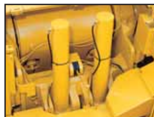
Meccanismo di protezione del frantoio idraulico
