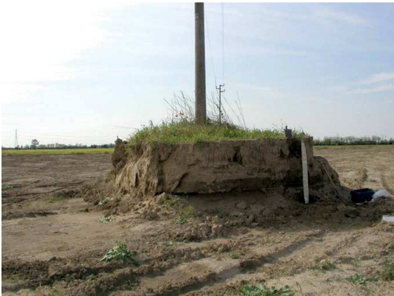
Fig. 6.5 - Abbassamento del piano di campagna di circa 1,5 m nell'ambito di una migliona fondiaria.
