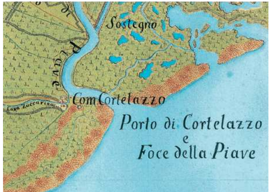
Fig. 9.1 - Cordon di Jesolo - Cortellazzo. Nella carta sono messi in evidenza con il colore marrone i sistemi di dune che bordavano l'intero litorale nord adriatico e che isolavano aree paludose, oggi bonificate, alle spalle degli apparati costieri (ANTON VON ZACH, Topographisch - geometrische Kriegskarte von dem Herzogthum Venedig . 1798-1805, scala originale 1:28.800).
