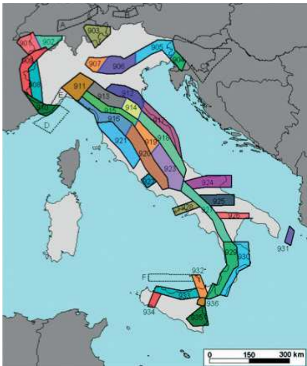
Fig. 10.2 - Zonazione Sismogenetica ZS9, a cura del Istituto Nazionale di Geofisica e Vulcanologia.
