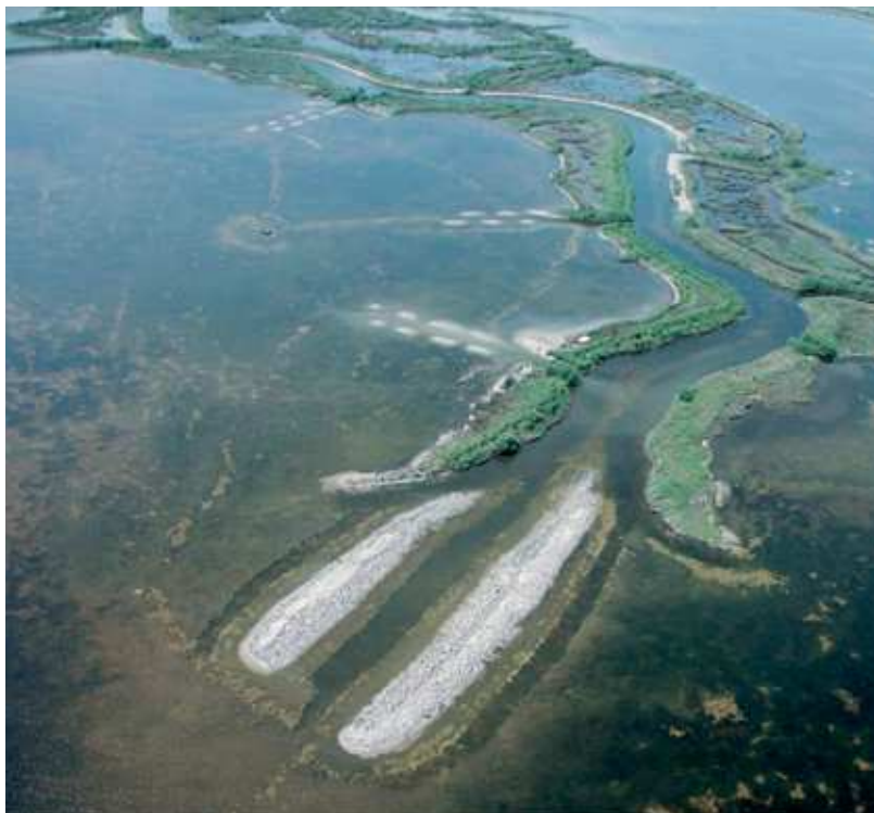
Fig. 9.4 - Laguna di Caorle, Val Nova: bocca di un canale lagunare con in primo piano l'accumulo dei sedimenti dragati al suo interno.
