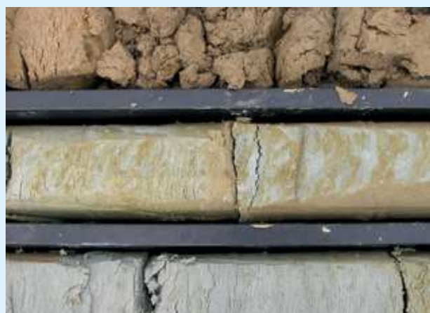
Fig. 8.17 - Il suolo "caranto" sepolto da depositi post-LGM, osservato in carotaggio. L'orizzonte presenta molte screziature e piccole concrezioni di carbonato di calcio.
