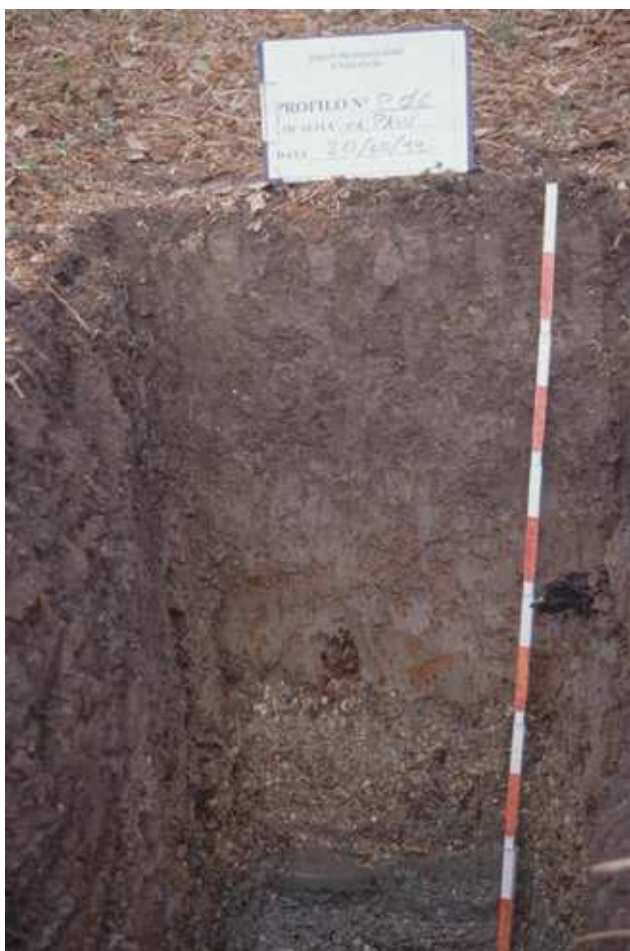
Fig. 6.12 - Suolo argilloso con orizzonte superficiale ricco di sostanza organica e ghiaia in profondità molto frequente nelle incisioni del Tagliamento occupate dai fiumi di risorgiva.
