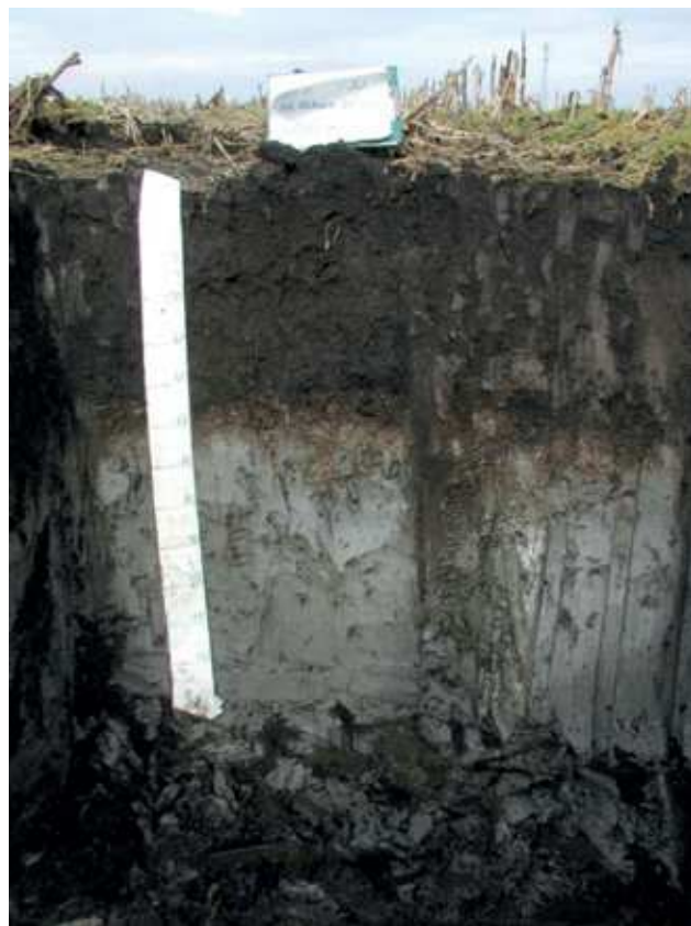
Fig. 6.9 - Suolo ad elevato contenuto di sostanza organica in superficie e con colori grigi in profondità per la presenza di falda.
