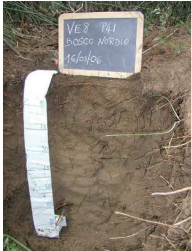
Fig. 6.15 - Suolo sabbioso di duna nell'area naturale di Bosco Nordio ( Protic Arenosols (Calcaric) ).
