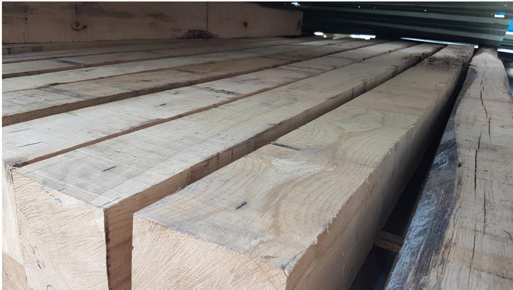
Figura 16: Recupero di legno in tavolati e travi da bricole di Venezia e Chioggia
