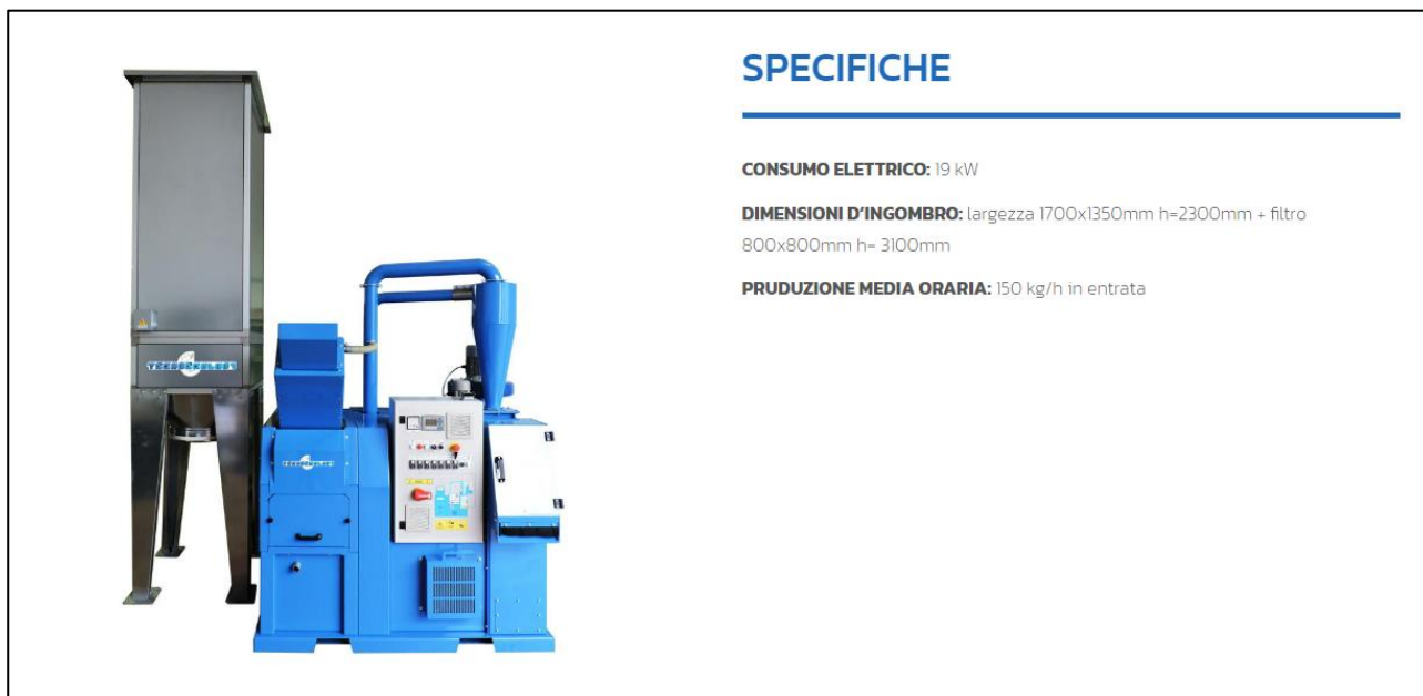
Figura 13: Dettagli tecnici dell'impianto di recupero del rame dai cavi
