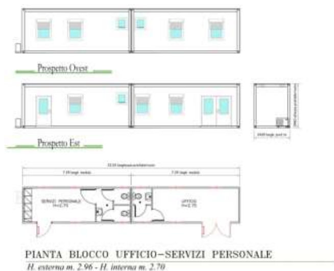
Figura 3-4 – Planimetria e prospetti immobili uso uffici e servizi
