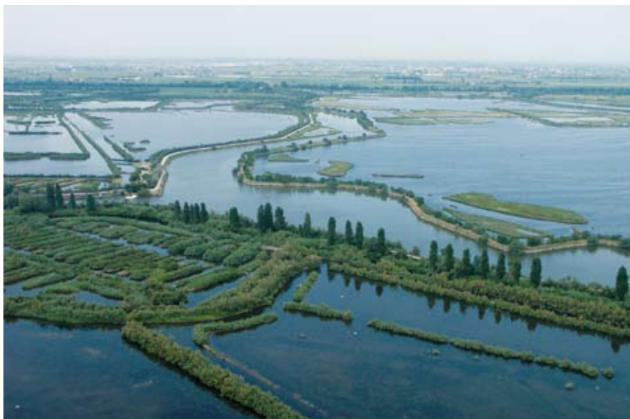
Valle Averso vista dalla laguna. Ampi specchi lagunari delimitati da argini molto spesso vegetati allo scopo di consolidare il terrapieno e proteggere le aree retrostanti dai venti. Sullo sfondo il Taglio Nuovissimo che fa da limite con la terraferma (foto Bondesan A. - Provincia di Venezia, 26/07/2004).
