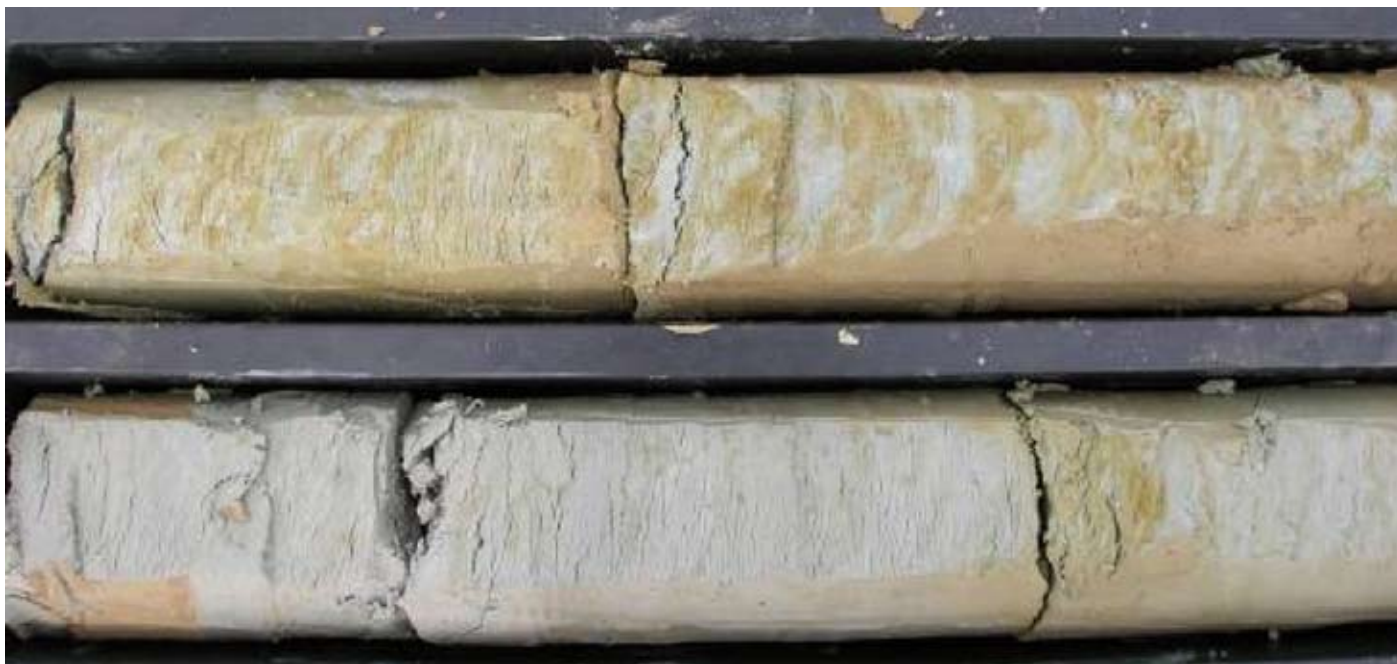
Gli orizzonti a caranto assumono un aspetto alquanto tipico nelle "carote" prelevate da un sondaggio condotto nei pressi di Malcontenta (foto J. Perin, 29/04/2005).
