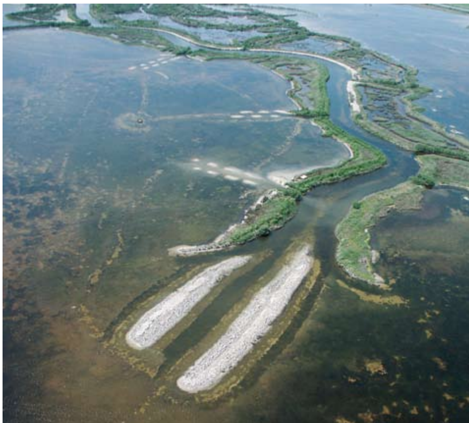
Laguna di Caorle, Val Nova; bocca di un canale lagunare con in primo piano l'accumulo dei sedimenti dragati al suo interno (foto Bondesan A. - Provincia di Venezia, 18/05/2004).
