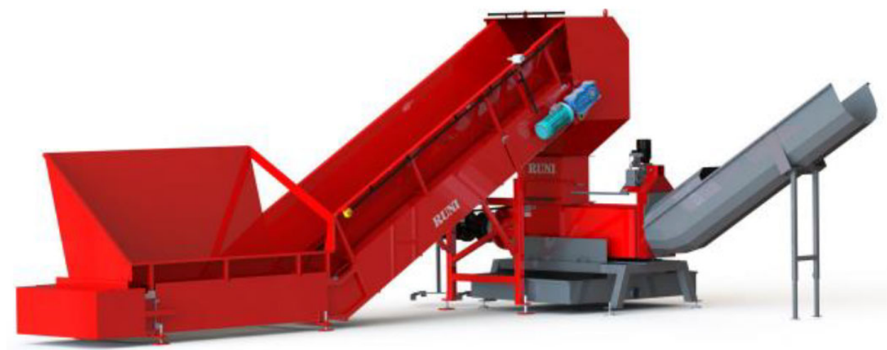
Figura 2. Rappresentazione dell'impianto di strizzatura/schiacciatura
