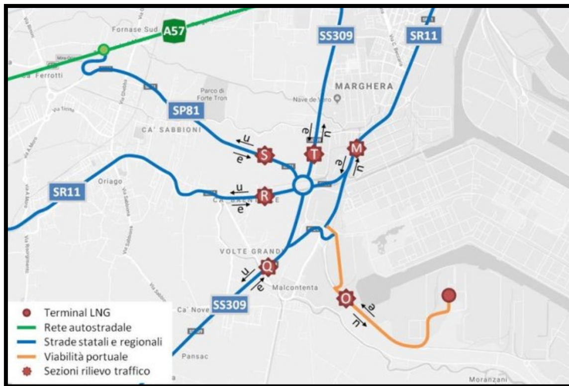
Fig. 20 – Collocazione delle sezioni di rilievo per la caratterizzazione del traffico tratta dallo Studio LNG
