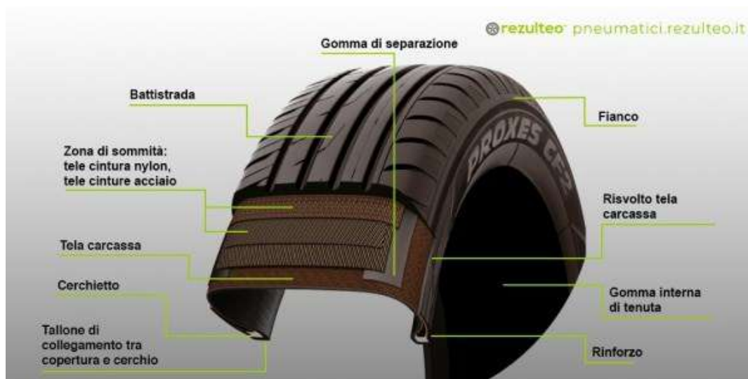
Immagine n. 13 – Struttura di uno pneumatico
