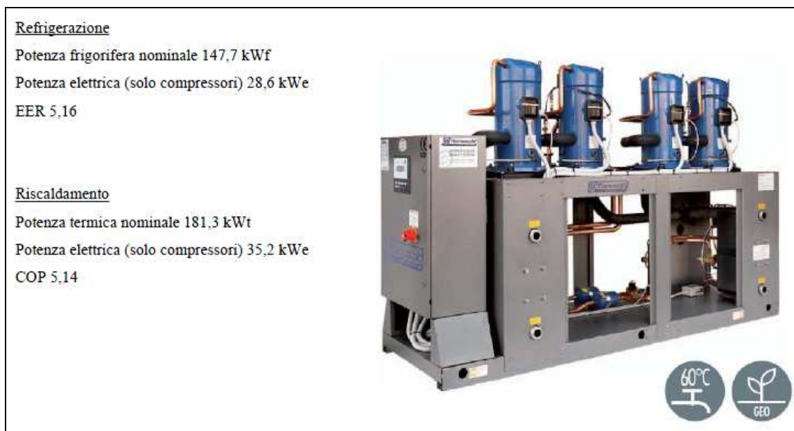
Figura 2.9 – Dati del singolo gruppo frigorifero (fonte: Relazione Generale)
