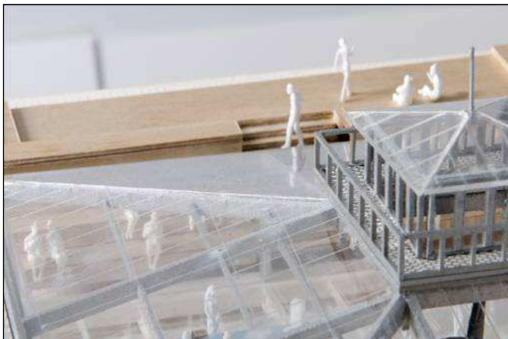
Figura 2.6 - Pannelli di vetro "okagel" della copertura del padiglione (fonte: Relazione Generale)
