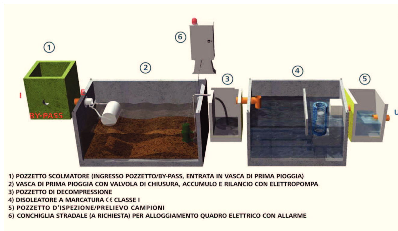
Fig. 5 – Schema funzionale dell'impianto di trattamento delle acque di prima pioggia
