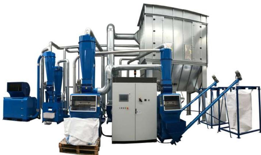
Info utilizzo: Il T1500 è un impianto per il riciclaggio del rame o dell'alluminio contenuti nei cavi elettrici dall'involucro di gomma o pvc . Adatto anche per il trattamento del cavo rigido, trae vantaggio dal circuito aperto dell'aria per risolvere i problemi di surriscaldamento del materiale.
