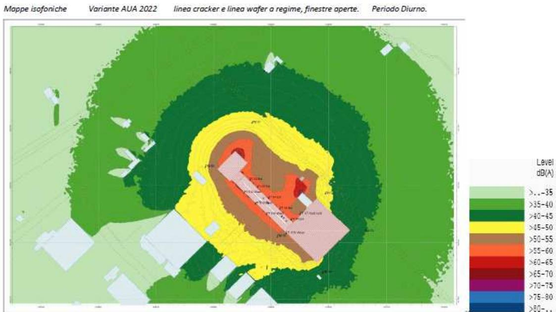
Figura 12. Risultati della simulazione dei livelli di immissione in fase di esercizio dello stabilimento a seguito attivazione nuova linea wafer
