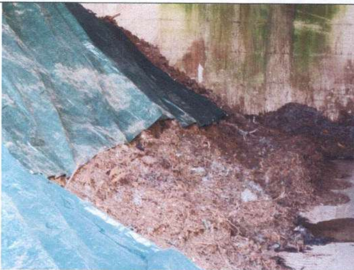
Foto 13 – cumulo n. 2 in fase di biossidazione
